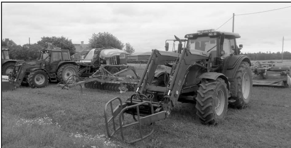
Tilan kalustoa. Uusi paalain paalaa ja muovittaa pyöröpaalit mikä nopeuttaa työtä.
