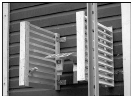
Ilmanpaine-, kosteus- ja lämpöantureille on auringolta suojaavien metsien hakuiden myötä jouduttu rakentamaan valosuojat koilliselle ja lounaiselle sivulle.
